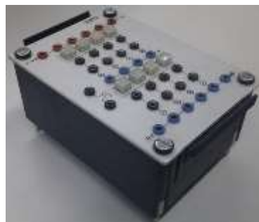
Rys. 9 Wskaźnik połączeń a) widok wskaźnika połączeń, b) symbol wskaźnika świetlnego, c) symbol sygnalizatora akustycznego
