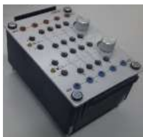
Rys.5. Zestaw przekaźników czasowych: a) widok zestawu przekaźników czasowych, b) symbol przekaźnika czasowego ze zwłocznym załączaniem, c) symbol przekaźnika czasowego ze zwłocznym zwalnianiem
